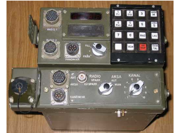
AKSA enhet från SRA Funktionen realiserad med diskreta IC-kretsar
