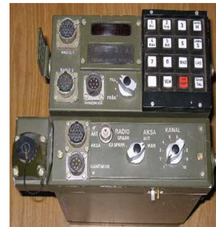
AKSA enhet från SRA Funktionen realiserad med diskreta IC-kretsar
