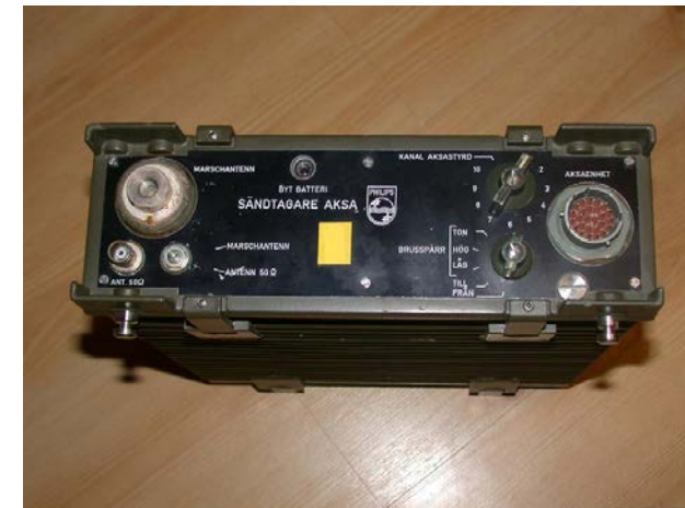
AKSA enhet från Philips Funktionen realiserad med mikroprocessor.
