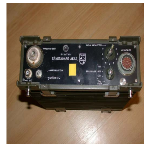
AKSA enhet från Philips Funktionen realiserad med mikroprocessor.
